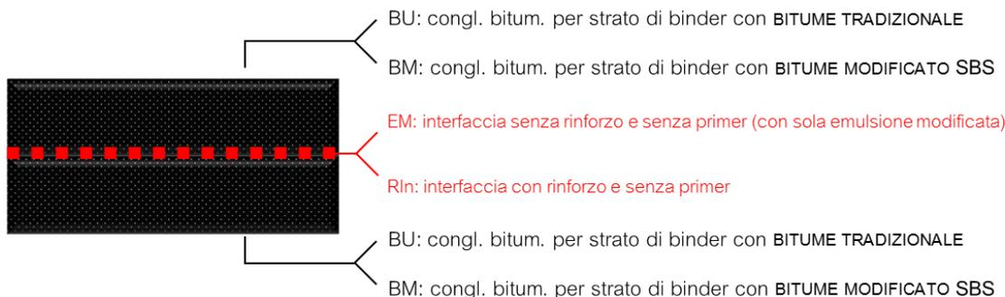
Figura 2.5. Configurazione sistema bistrato Fase 1
